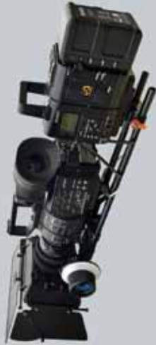
HXR-FR5 인터페이스 유닛, AXS-R5레코더 및 BP-FL75 배터리를 탑재한 NEX-FS700 카메라
